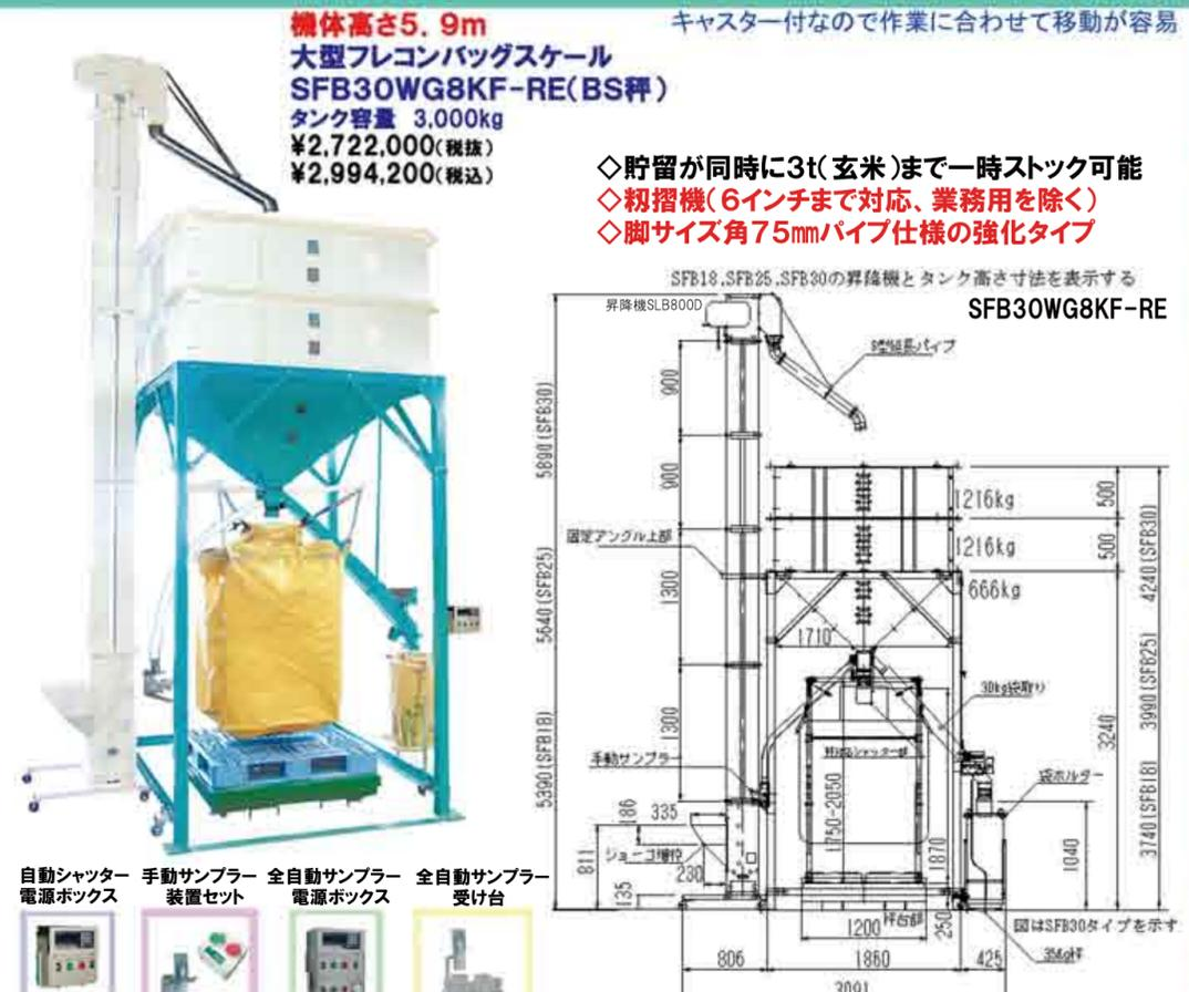
SFB18、SFB25、SFB30の昇降機とタンク高さ寸法を表示する SFB30WG8KF-RE
