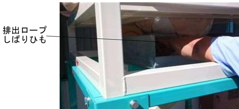
注) 排出後、専用パレットを移動させる前に、飛散防止枠を取り出してください。
