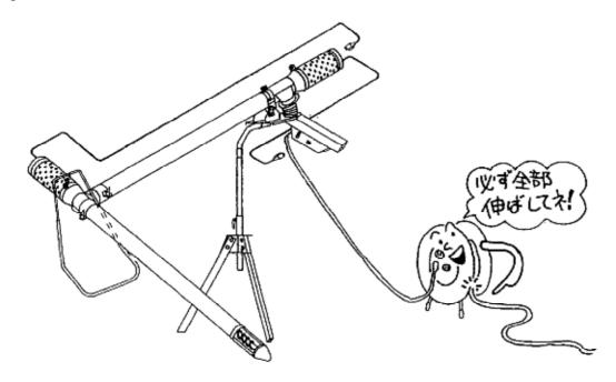
▲注意 長いコードを使用すると、電圧低下をきたし、モーターの過負荷や誤動作の原因となります。コードリールを使用するときには、コードを巻いたままにしないで全部伸ばして使用してください。
