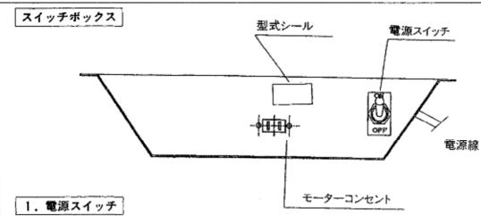
電源スイッチ「ON/OFF」を押すとモーターの起動 (ON) 停止 (OFF) を行います。
