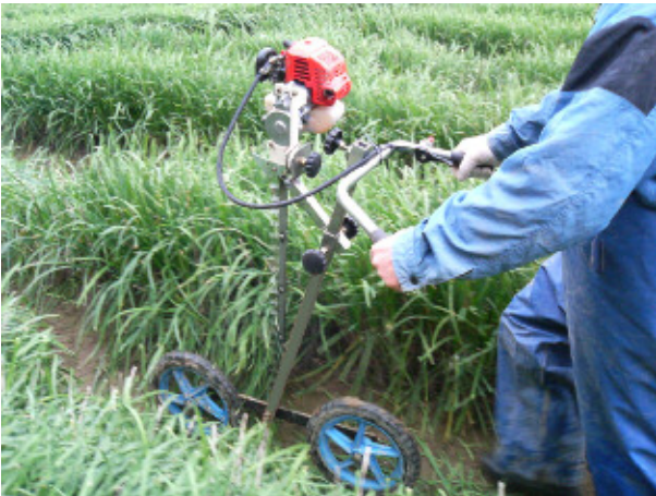
＜参考＞ニラの剪定作業風景 （角度 9 0 度作業時）
