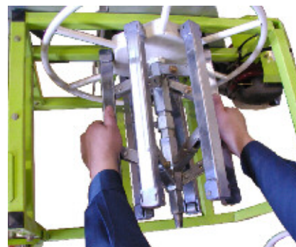
④巻取り部に手を挟まない様気を付けて広げます。(写真の様な持ち方をしてください)
