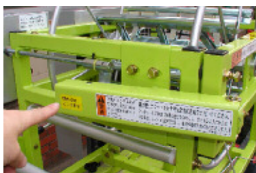
⑤巻取り部を広げた後はサイドリングをはめて、とびらを戻し、フックを掛けてクランプの「閉める時ここを押す」のところを押して閉めます。
