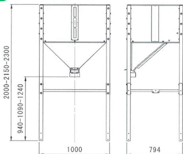
タンクと脚の取付位置を変えることで高さが3段階選べます◎
